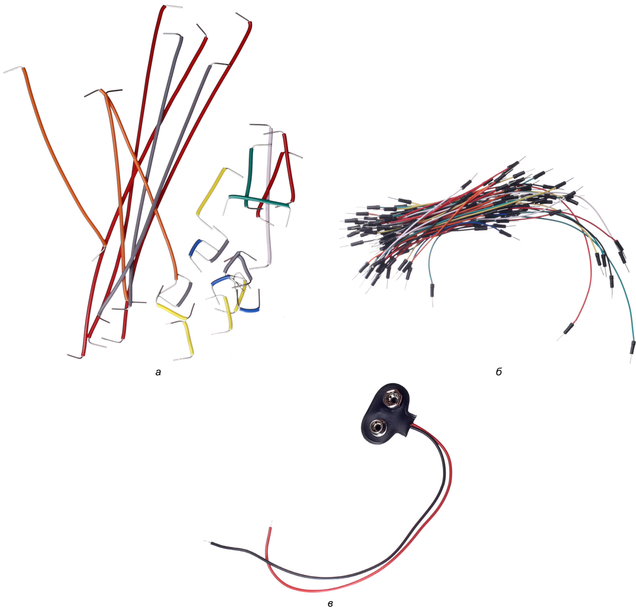
Рис. Ц-2.4. Жесткие перемычки (а); гибкие перемычки (б); колодка для батарейки типа «Крона» (в)
